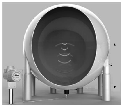
图1 声呐回波测距原理
